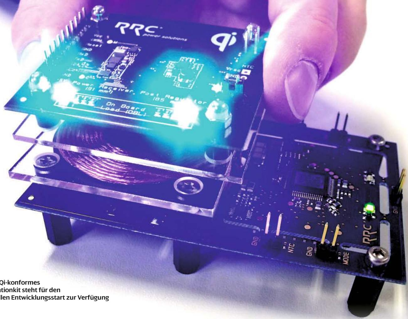
3 Ein Qi-konformes Evaluationkit steht für den schnellen Entwicklungsstart zur Verfügung
